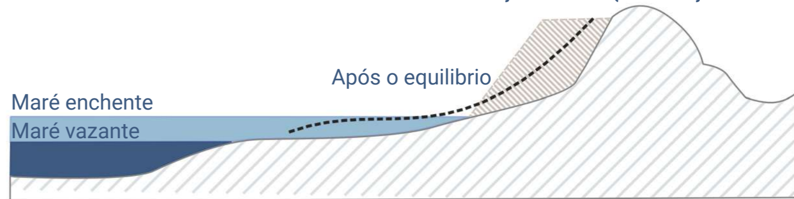
Reforço da duna (em direção ao mar)
