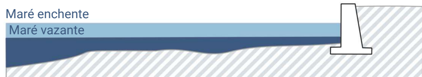
Figura 38: Corte diagramático da contribuição do paredão no aumento da erosão. Fonte: Elaborado pelo autor
